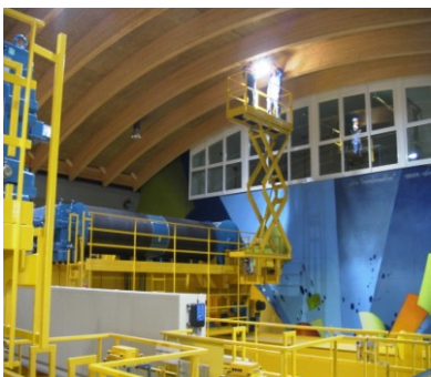
作为行车附加设备 用来进行屋顶设备检修的 剪叉式升降平台
