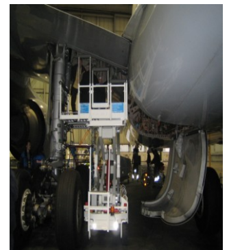
剪叉式升降平台用于飞机制造业的安装和检修工作
