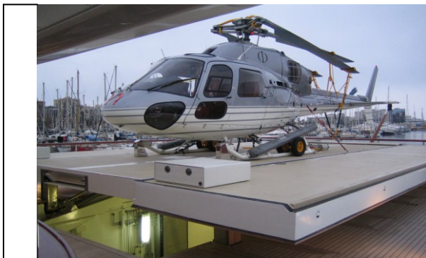
在摩托艇上可全部隐藏在船身内部的，用于停放直升机的剪叉式升降平台
