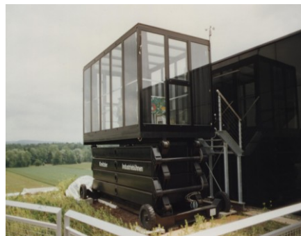
带有玻璃屋的自行剪叉式升降平台 用于高空观测
