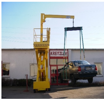
可进行侧面吊装的剪叉式升降平台
