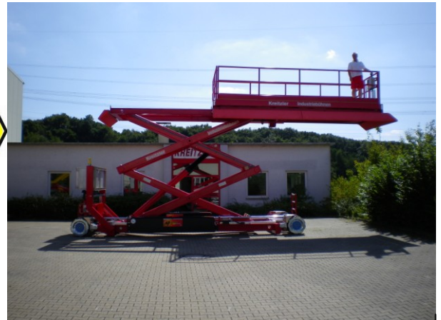
依据欧洲防爆标准制造的剪叉式升降平台，带有特种万向轮胎，侧面防护环装置，和一个可以向两侧平移的工作平台（横向和纵向），适用于飞机喷漆作业方面的工作。
