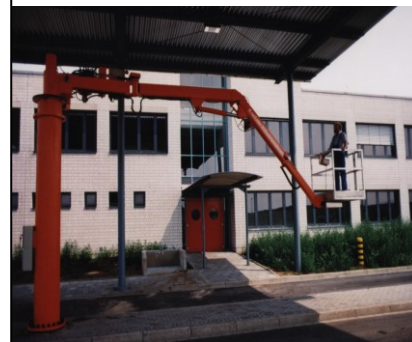
垃圾处理场内安装的固定检查设备
