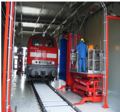
用于火车车厢清洗的自行剪叉式升降平台
