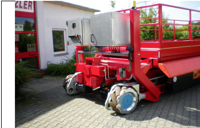
依据欧洲防爆标准制造的剪叉式升降平台，带有特种万向轮胎，侧面防护环装置，和一个可以向两侧平移的工作平台（横向和纵向），适用于飞机喷漆作业方面的工作。
