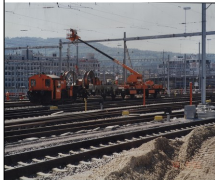
带有 550kg 承载量的用于火车铁路建设的直臂折臂式高空作业车
